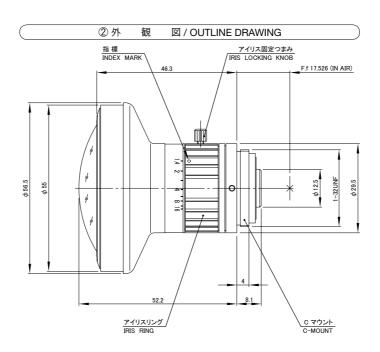
(単位 / unit: mm) F.f: フランジバック / Flange focal length IN AIR: 空気換算長
